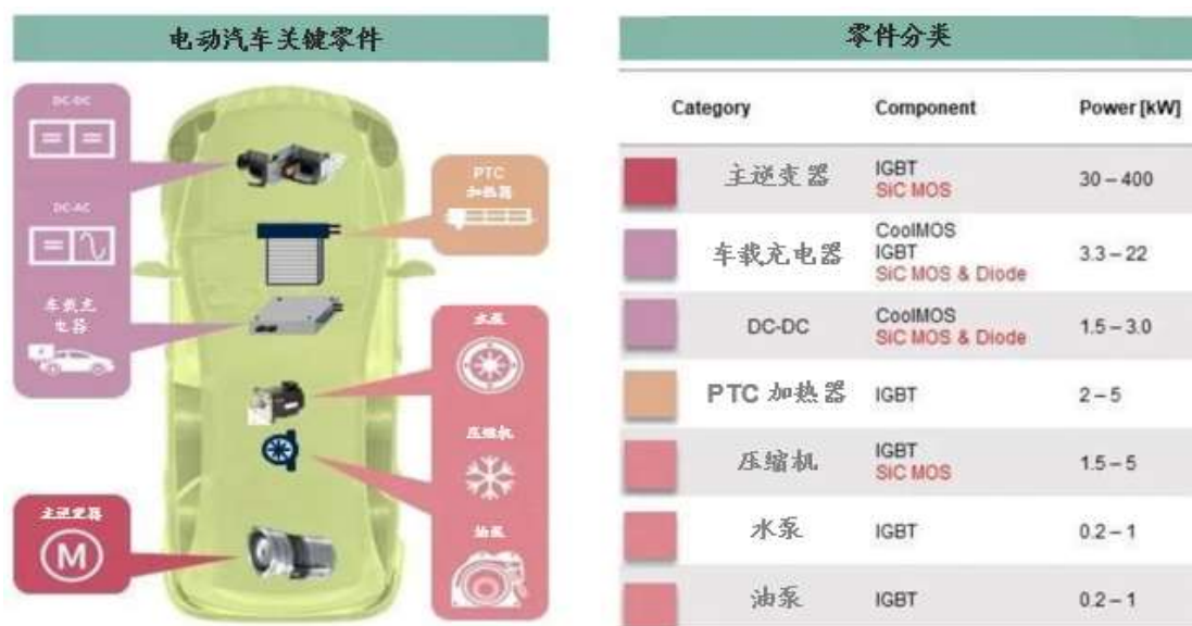
图 2：不同电动程度电动汽车功率器件作用及功率范围
