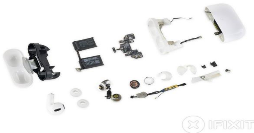
图 50: AirPods Pro 拆解图
