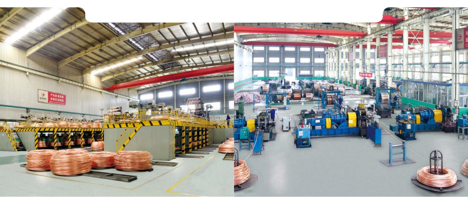
采用SYLZ15000/24/20上引法无氧铜连铸机组,由上海电缆研究所设计并监制,是生产高 质量、大长度光亮φ8~φ30mm铸态无氧铜杆的专用设备,该机组将电解铜板通过上引法连铸 生产成无氧铜杆,其工艺先进且产品质量高。
