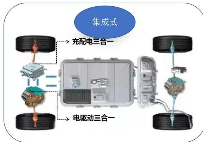
2018年，分体式90kw电驱动系统电机、电控、减速箱、高压连接线束总价在11000元左右；2020年，集成式90KW电驱动系统平均产品价格已经降到了7500元左右，降幅超过30%，同时体积和重量也下降明显。
