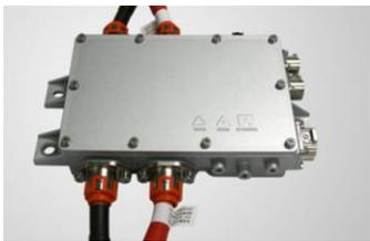
高压配电箱是电动汽车、插电式混合动力汽车电能分配单元，主要连接的部件有动力电池组、车载充电机、电机控制器、DC/DC变换器、电动空调、PTC等高压电气设备。
